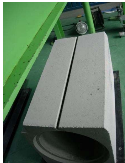
供試体スリット部
