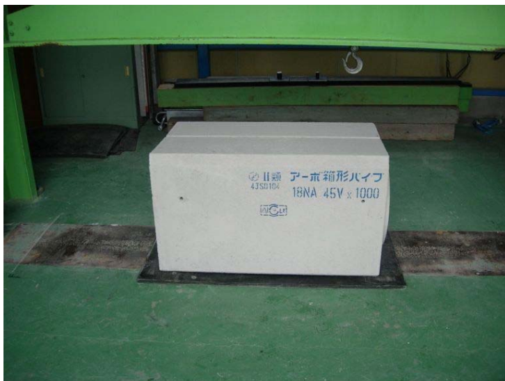
供試体設置状況
