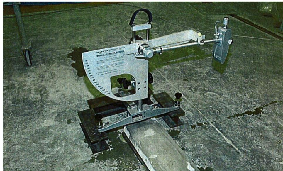
写真 すべり試験状況（幅方向の場合）
