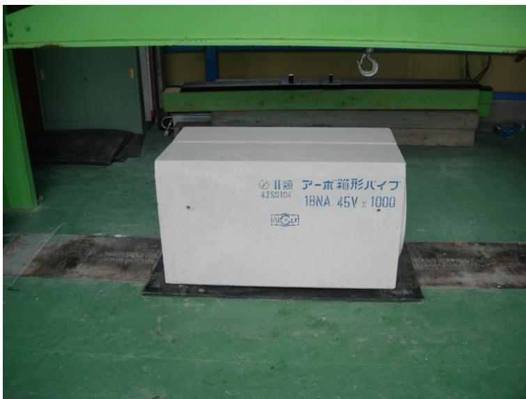
供試体設置状況
