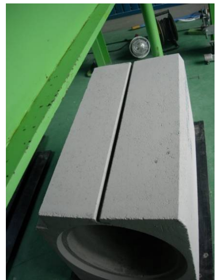
供試体スリット部
